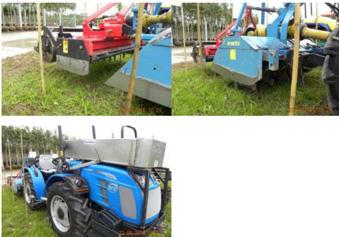
Afbeelding 3. Best practices onkruidbestrijding: frezen, eggen i.c.m. rijbespuiting
